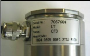
Der Kalibriercode befindet sich auf einem Label am Messkopf. Entfernen Sie dieses Label nicht bzw. notieren Sie sich den Code, da dieser bei einem Tausch der Elektronik benötigt wird.
